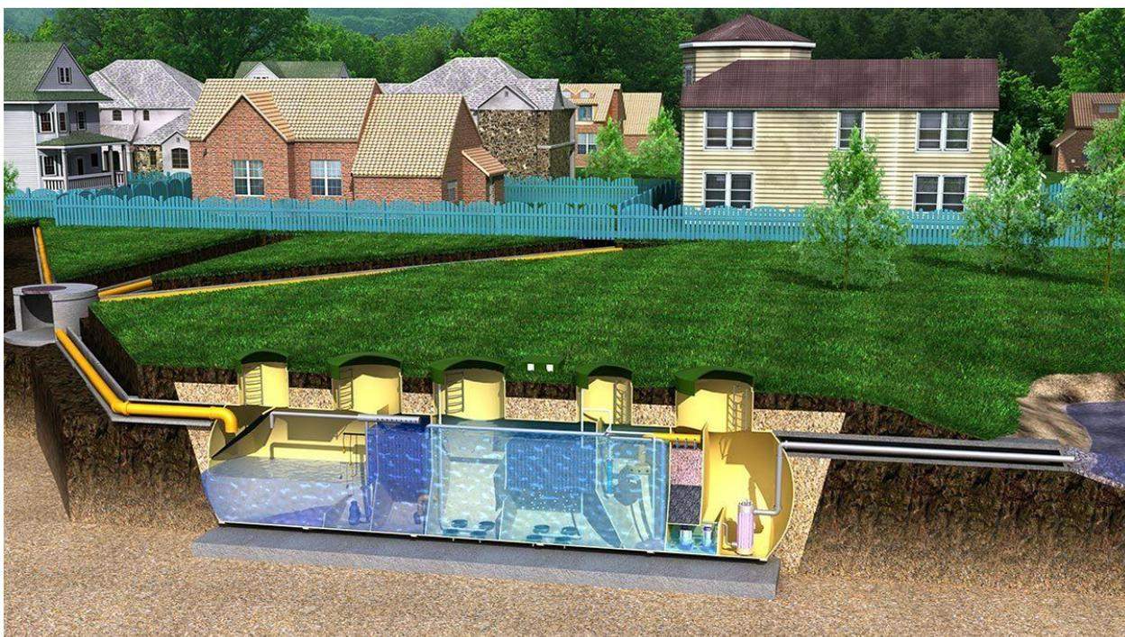
**Рисунок 7. Схема биологической очистной станции.**
