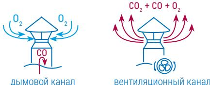
При одновременной работе газового котла или колонки и электрической вытяжки продукты сгорания, которые образуются при работе газового оборудования, начинают поступать в помещение.
